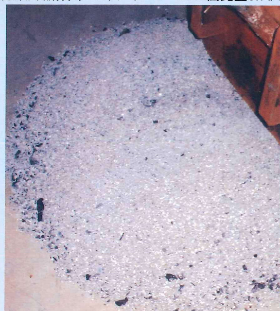
④焼却灰(減容率7%)サイズ0~3mm嵩比重0.7t/m³
